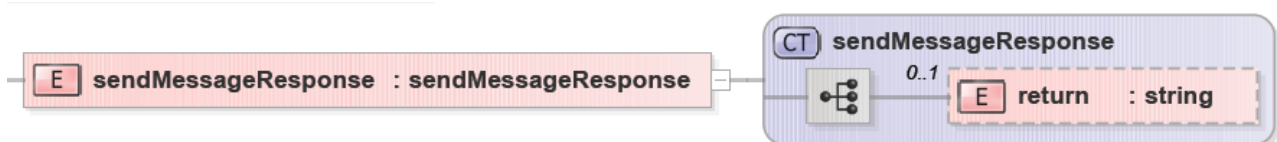
15. ábra: A sendMessageResponse adatcsomag szerkezete
